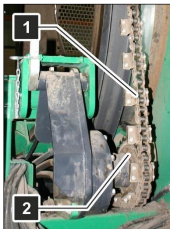
Afb. 114: zeeftrommel SM620 - ketting plaatsen
