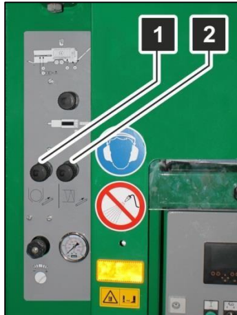
Afb. 11: snelheid afvoerbanden wijzigen
