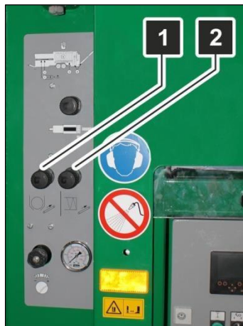
Afb. 66: snelheid afvoerbanden wijzigen
