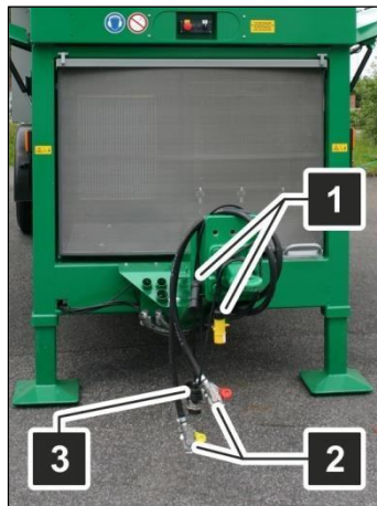
Afb. 44: aansluiten van perslucht
