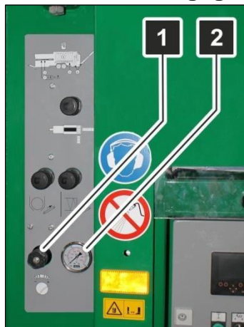
Afb. 64: vullingsgraad zeeftrommel optimaliseren
